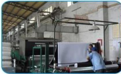
橡胶发泡生产线
